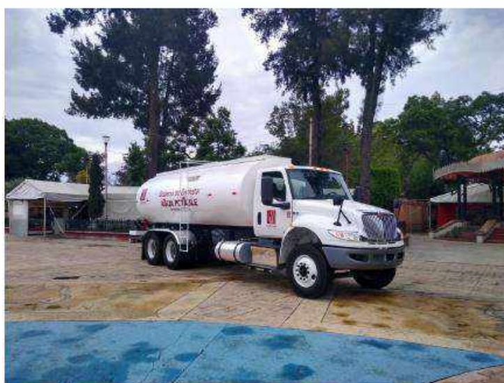
Camión cisterna o pipa de 20,000 litros para distribución de agua potable
