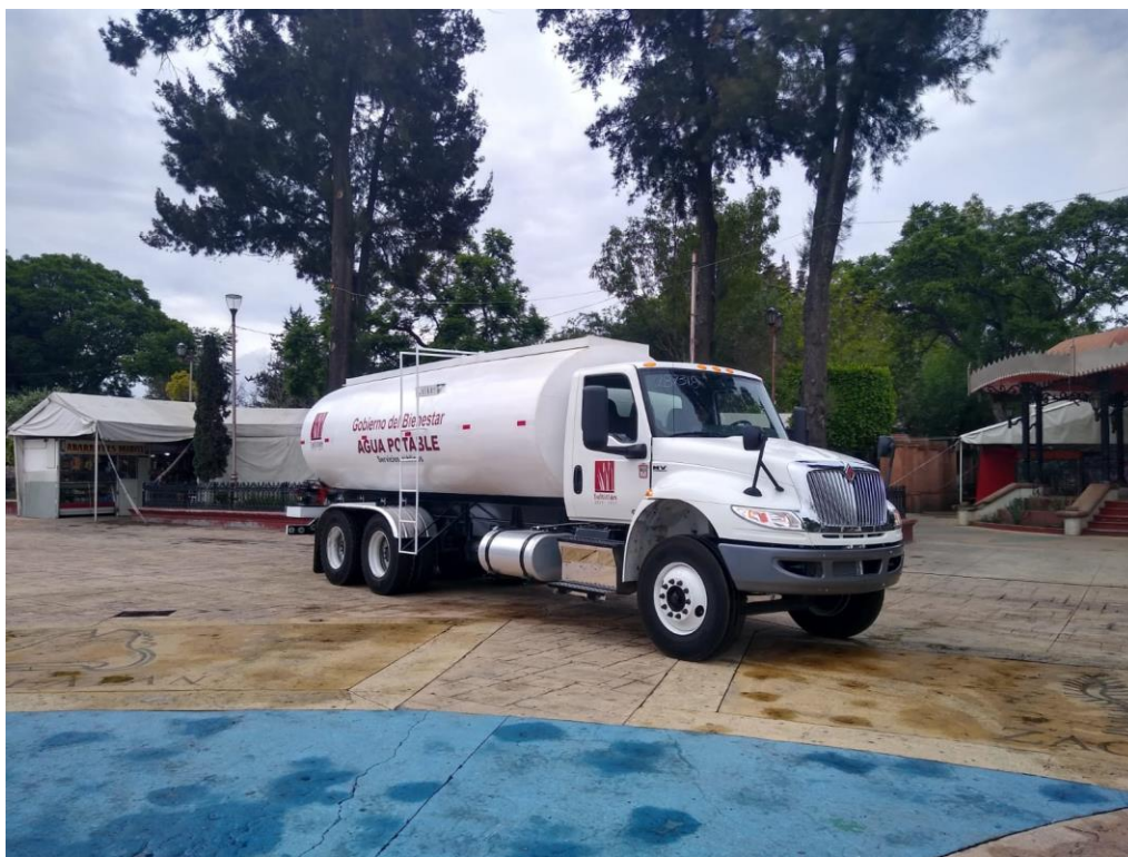
Camión cisterna o pipa de 20,000 litros para distribución de agua potable
