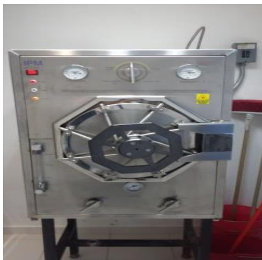
Autoclave de Vapor Clínica DIF Tejados
