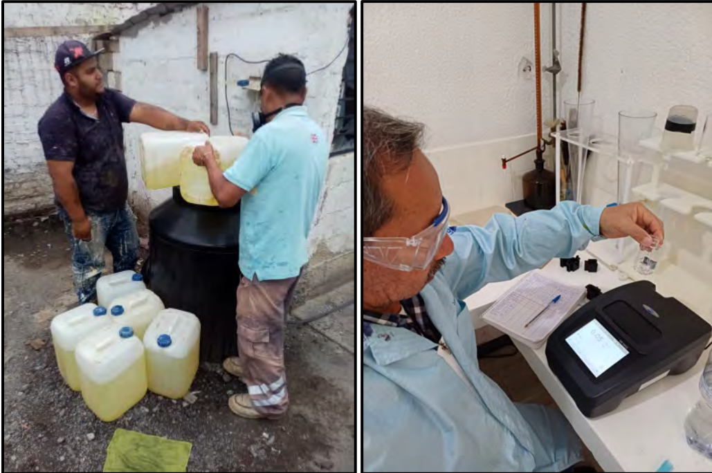
A la izquierda, el personal de Personal de la CAEM recargando de hipoclorito de sodio/ A la derecha, Biólogo realiza análisis de calidad del agua potable en Pozos de Tultitlán, 2024.
